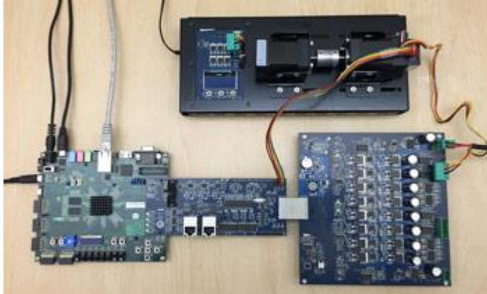
圖 2：帶有選擇性測力計系統的 Zynq Intelligent Drives Kit II (圖來自 Avnet Electronics 行銷部)。
